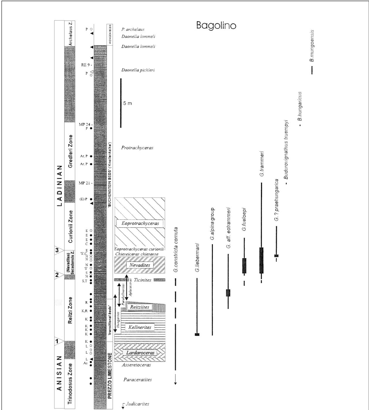
Fig. 2 - La sezione di Bagolino (Giudicarie, Brescia), con la biozonazione ad ammonoidi, l'indicazione dei principali bioeventi a conodonti e le diverse posizioni proposte per il limite Anisico/Ladinico (1-2-3) (da NICORA & BRACK, 1995).
