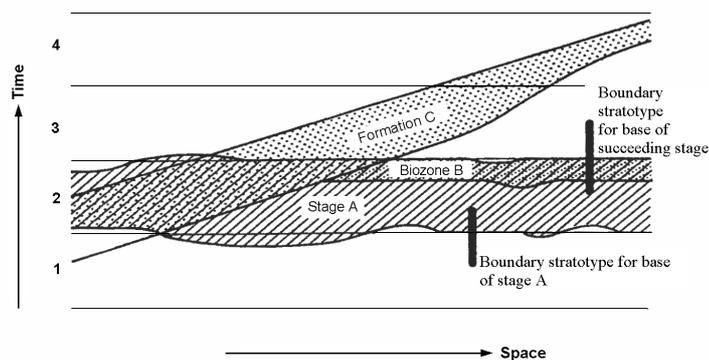
Fig. 2 - Caratteri e significato dei vari stratotipi in stratigrafia (da COWIE & BASSETT, 1990).
